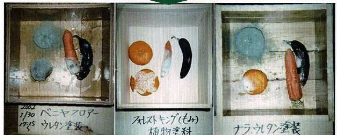
カビ発生(目視確認)
